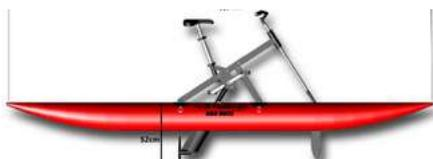
Red Shark est un vélo marin monocoque qui permet de se promener au sec sur les plans d'eau comme vous en avez rêvé. La formule monocoque choisie offre l'avantage d'une stabilité hors pair. Le gouvernail est situé à l'avant et est relevable en cas de choc, sa position avancée rend la conduite du Red Shark totalement comparable à celle d'un vélo routier, aucun temps d'adaptation nécessaire.
